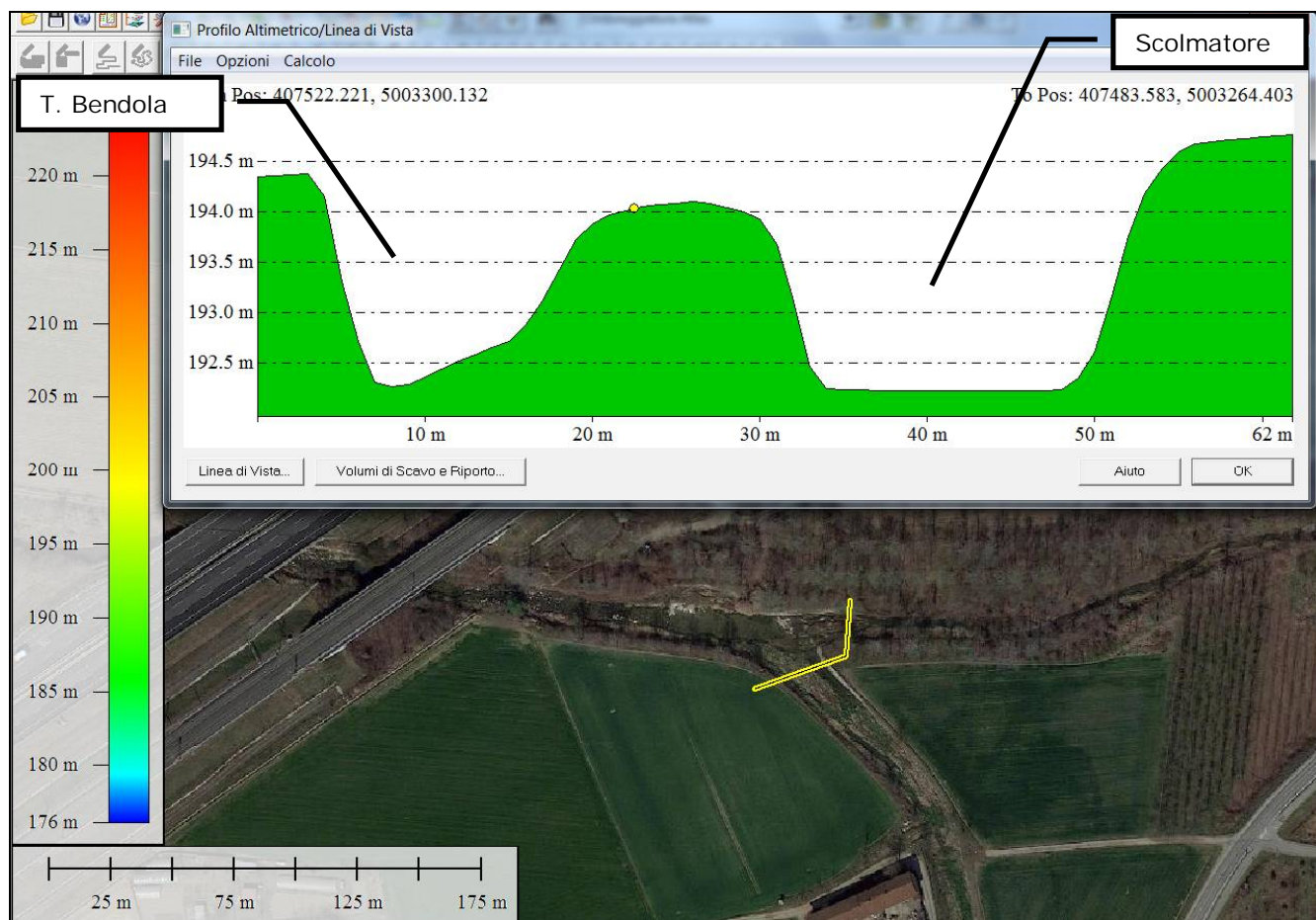
Figura 2-18. Sezione longitudinale del T. Bendola e del canale scolmatore all'altezza della diramazione (vista da monte verso valle). La base altimetrica (DTM) è stata elaborata in ambiente GIS (Global Mapper® 13.0).
